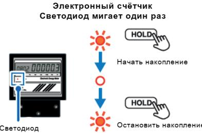
Для сравнения стационарного электросчётика: возьмём в качестве примера 0,1 кВт·ч. Нажмите кнопку «Hold» (Удержание), чтобы начать накопление, когда значение изменится на 0,1 кВт·ч; нажмите «Hold» снова, чтобы остановить накопление, когда значение снова изменится на 0,1 кВт·ч, как показано ниже:
