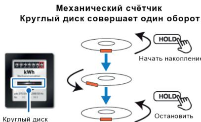
Для сравнения с электронным счётчиком: нажмите кнопку «Hold» (Удержание), чтобы начать накопление, когда светодиод мигнет один раз; нажмите «Hold» снова, чтобы остановить накопление, когда светодиод мигнет снова, как показано ниже:
