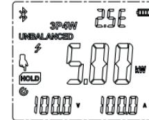
Символ пальца на кнопке "HOLD" мигает, чтобы указать на необходимость нажатия кнопки "HOLD" для перехода в интерфейс измерений P3.
